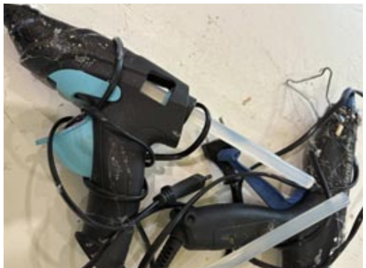
Da sieht man eine Heißklebepistole mit der man Pappen, Holz und viele Materialien kleben kann.
