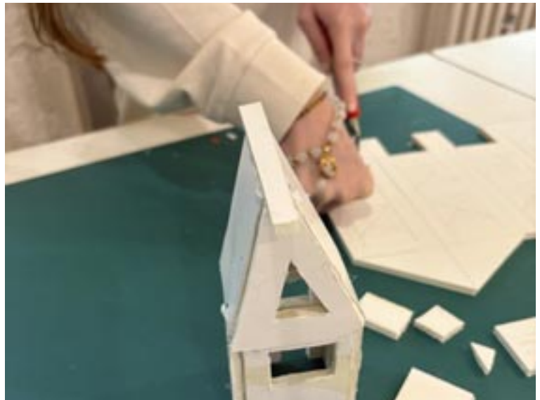
Das Bild zeigt wie ein Haus aus Modellpappe entsteht. Die Modellpappe wird mit einem Cutter geschnitten.
